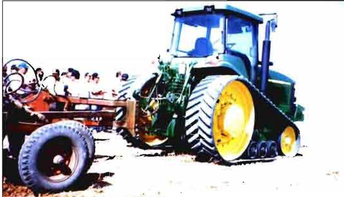
Tractor John Deere modelo 8300 T, equipado con orugas de goma con tacos, en prueba de tracción con un subsolador de 7 brazos.
