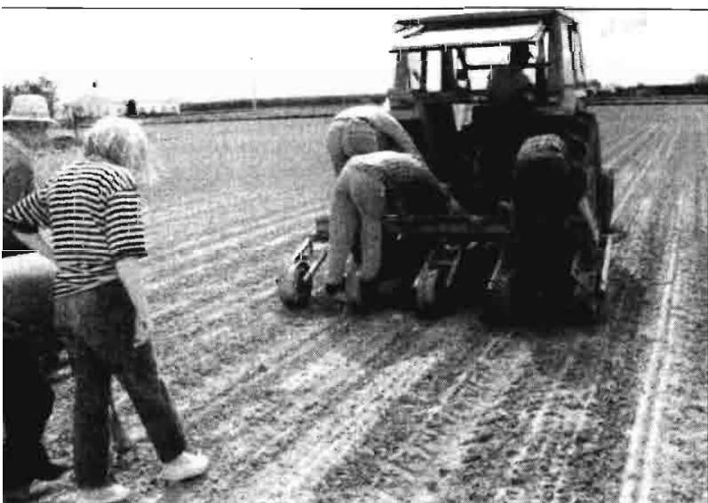
Artilugio aplicado con extintor para romper la costra en León (Páramo).
