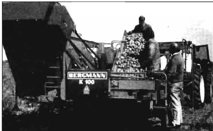
Cosechadora, integral de patatas, marca Bergman K-100-4, con sistema especial de separación de piedras.
