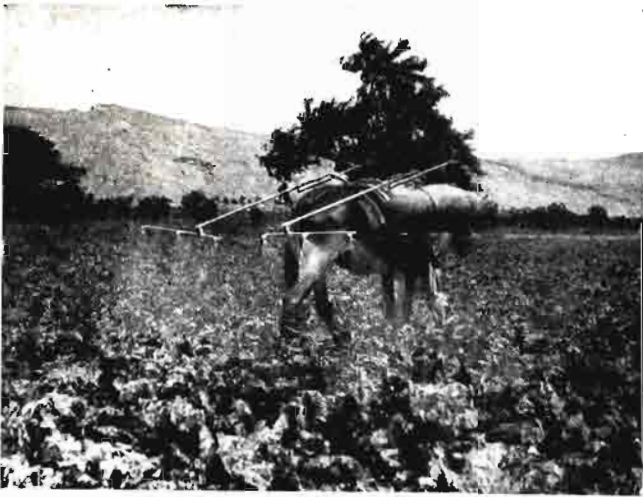
Disposición de las boquillas pulverizadoras en un aparato de albarda: del doble depósito que contiene (a presión) el caldo parasiticida, éste se distribuye por tuberías cuya altura y separación pueden graduarse.
