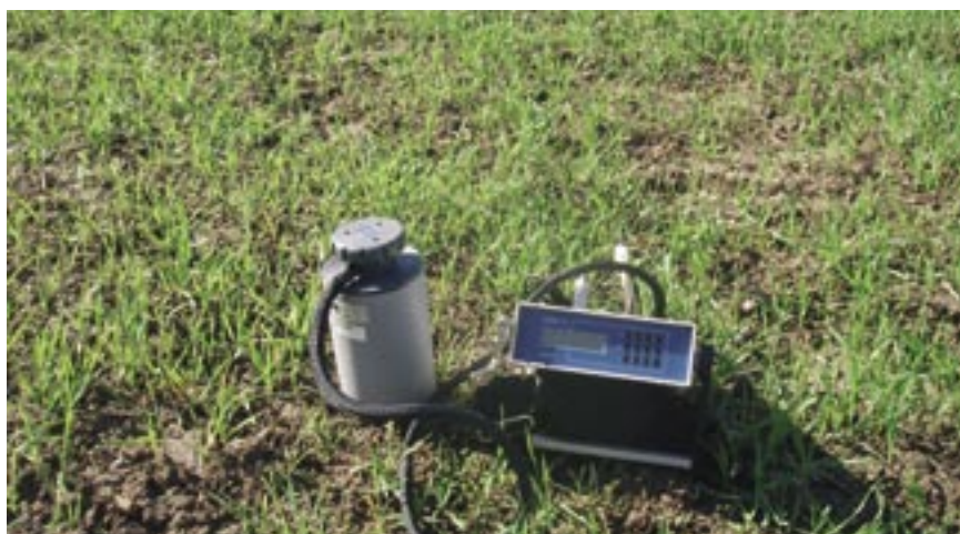
Equipo para medición de CO 2 procedente de la respiración del suelo y analizador de gases por infrarrojos.
