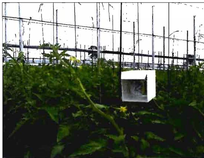
Invernadero con ventilación forzada y medidor de humedad.
