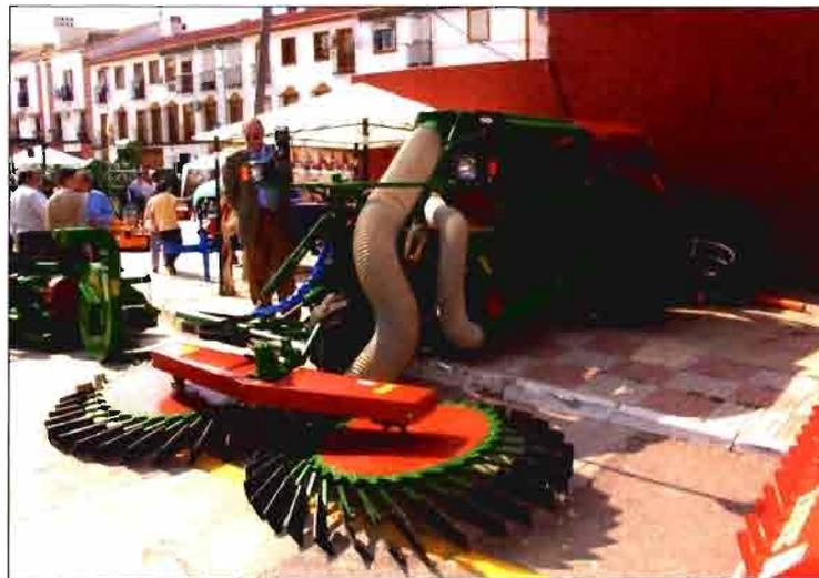
Foto 14. Barredora-aspiradora-limpiadora neumática.
