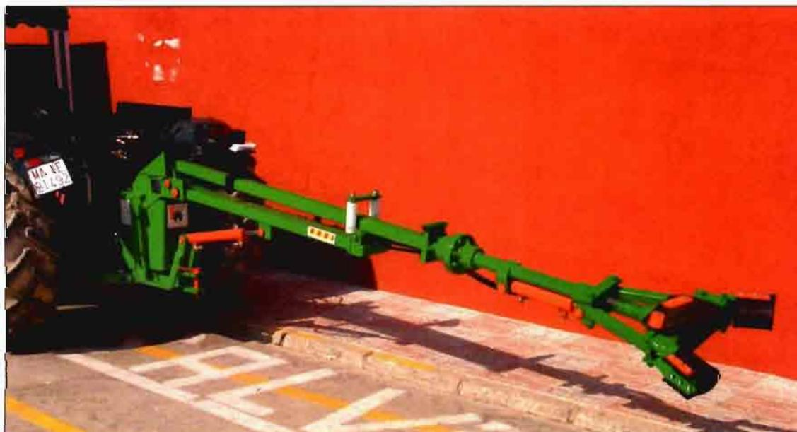
Foto 1. Vibrador unidireccional montado en tractor.
