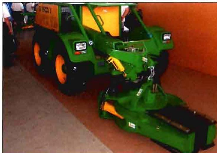
Foto 6. Vibrador autopropulsado.
