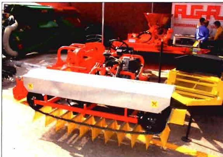
Foto 12. Barredora-hileradora mecánica.
