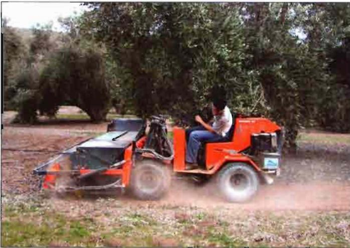
**Foto 6.** Recolección de aceituna empleando una barredora mecánica de gran capacidad de trabajo, trabajando en un olivar con los suelos bien preparados.
