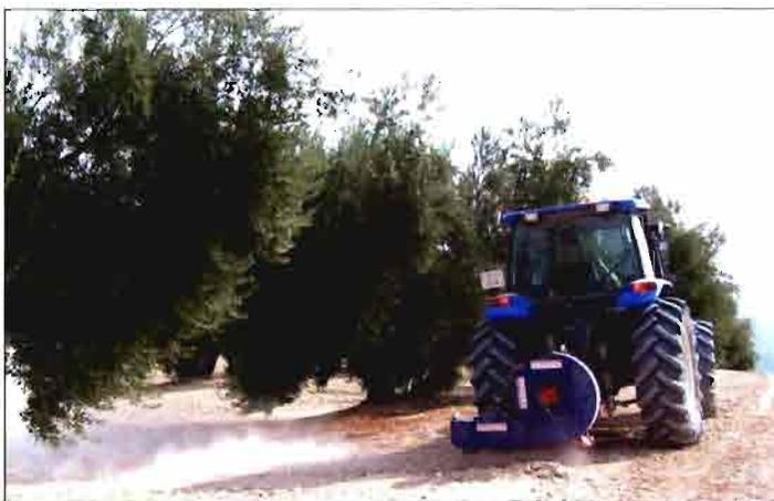
Foto 4. Como complemento al rulado del suelo (ver fotos 2 y 3), es frecuente que los olivereros eliminen las hojas bajo la copa de los árboles con sopladoras de gran potencia. Estas sopladoras son empleadas igualmente, durante el invierno, para barrer los frutos caídos al suelo.
