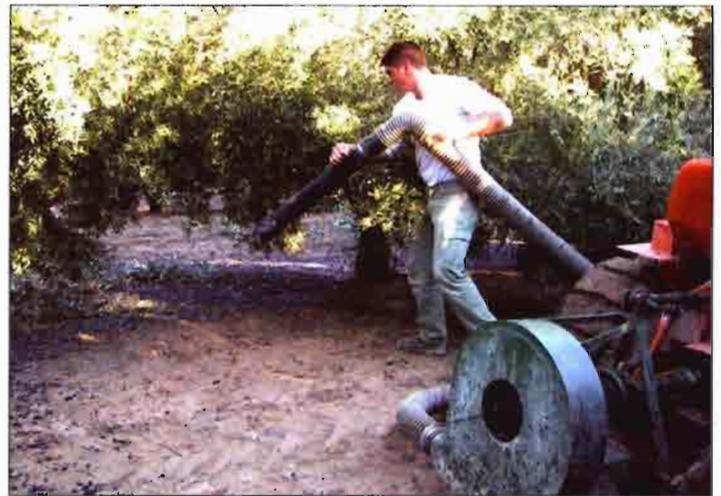
**Foto 7.** Las máquinas sopladoras de gran capacidad son una alternativa al empleo de las máquinas barredoras para la recolección de aceitunas del suelo. Trabajan aceptablemente en situaciones de suelo húmedo.
