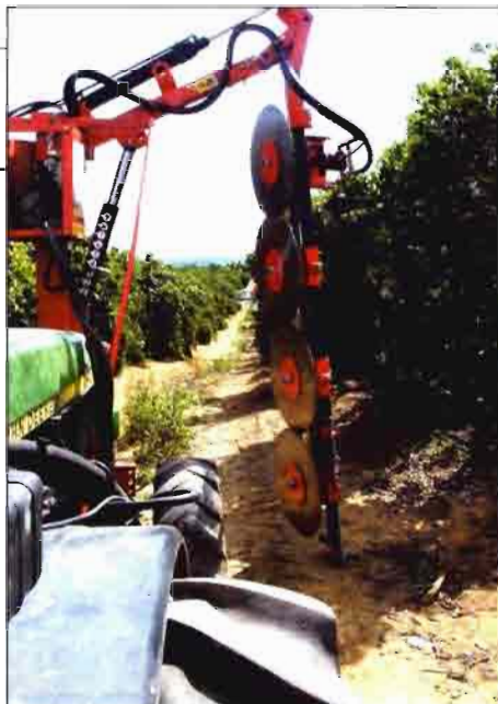
Foto 3 (arriba). Podadora mecánica de discos giratorios.
