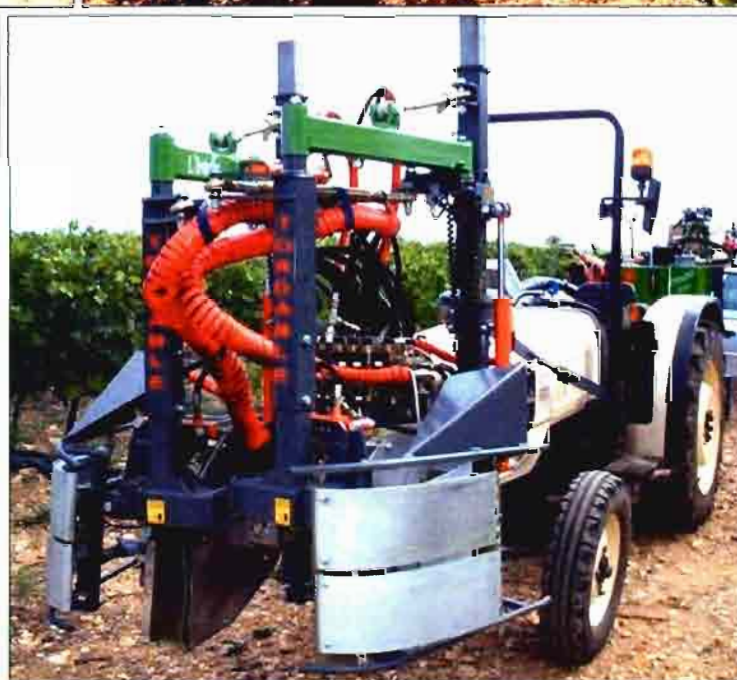
Foto 3 (arriba). Podadora mecánica de discos giratorios.
