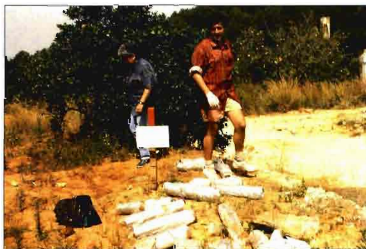
Toma de muestras de suelo inalterado para el estudio del comportamiento del aldicarb en zonas mediterráneas de regadío.
