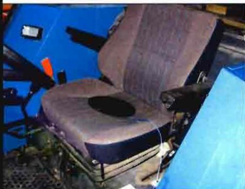
Foto 3. Acelerómetro triaxial para asientos.
