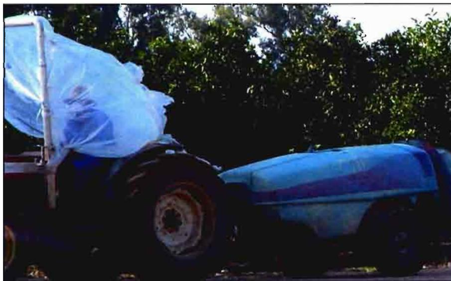
Figura 3. Ejemplo de protección en sustitución de cabina.
