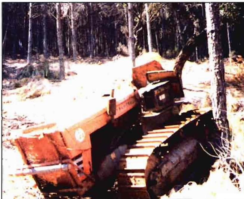
Figura 1. Tractor oruga tras un vuelco. La falta de cabina provocó la muerte de su conductor.
