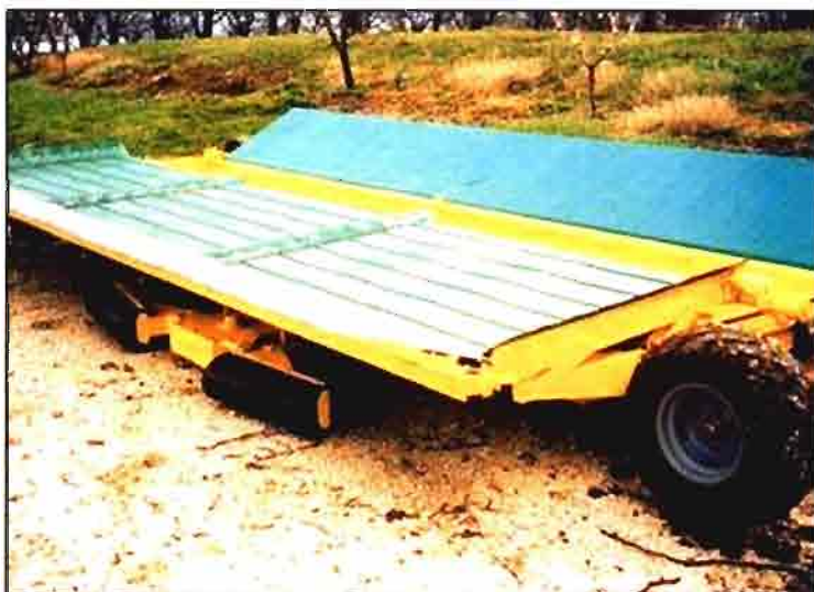
Figura 5. Vibrador arrastrado con plataforma de recepción.
