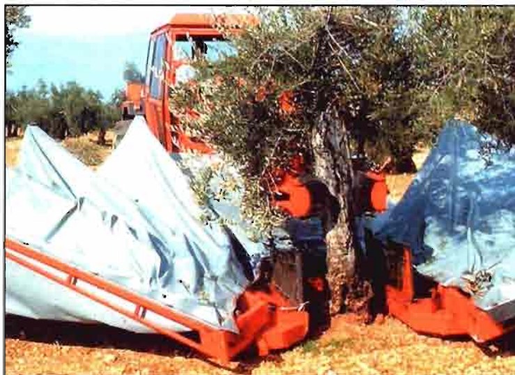
Figura 6. Vibrador frontal con paraguas invertido desplegándose bajo un olivo.
