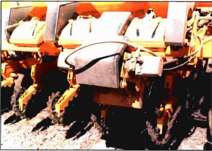
Figura 10. Sembradora-abonadora directa con Tecnología de Distribución Variable. (Prototipo INTA Manfredi).
