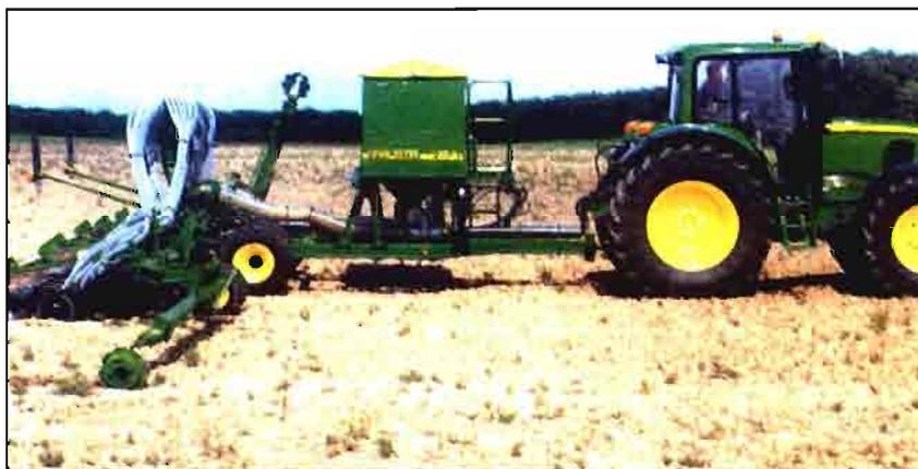
Figura 7. Sembradora de chorrillo arrastrada con sistema de georeferenciación y Tecnología de Distribución Variable (Doc. John Deere).
