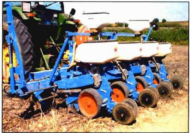
Figura 11. Sembradora neumática de precisión con dosificadores de microgránulos.
