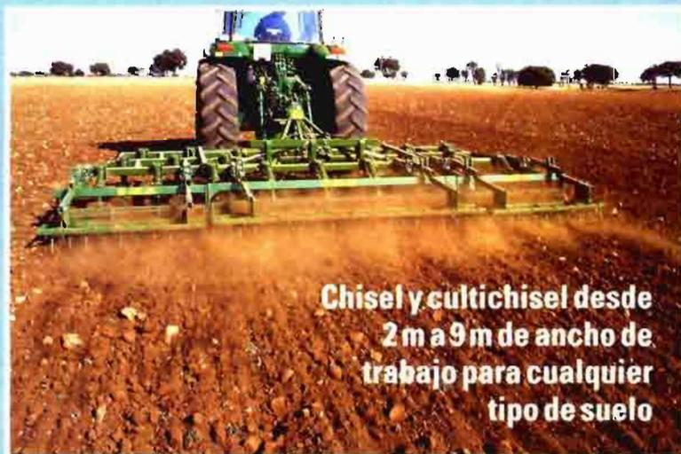
Chisel y cultichisel desde 2 m a 9 m de ancho de trabajo para cualquier tipo de suelo
