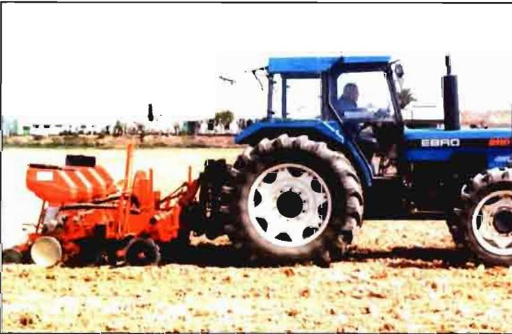
Figura 12. Sembradora neumática de precisión adaptada a siembra directa con discos para el corte de residuos.
