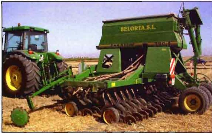
Figura 2. Sembradora neumática de 24 líneas de siembra.
