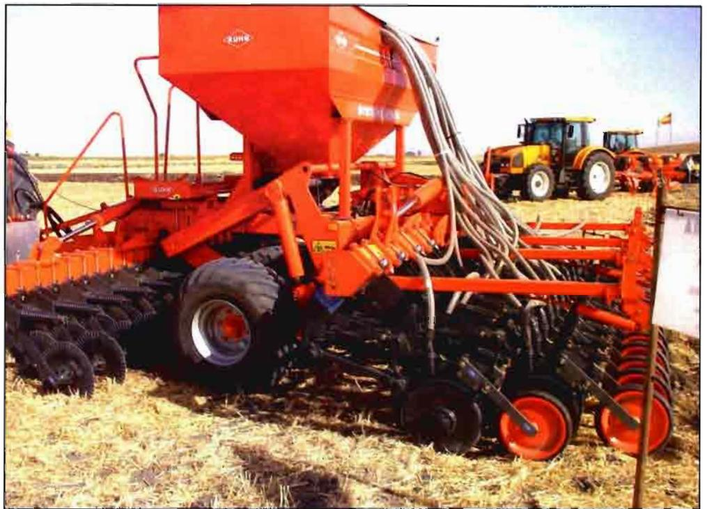
Figura 1. Sembradora neumtica con discos acanalados para el corte de residuos.
