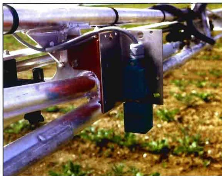
Figura 7. Dispositivo electrónico de control de altura de la barra.
