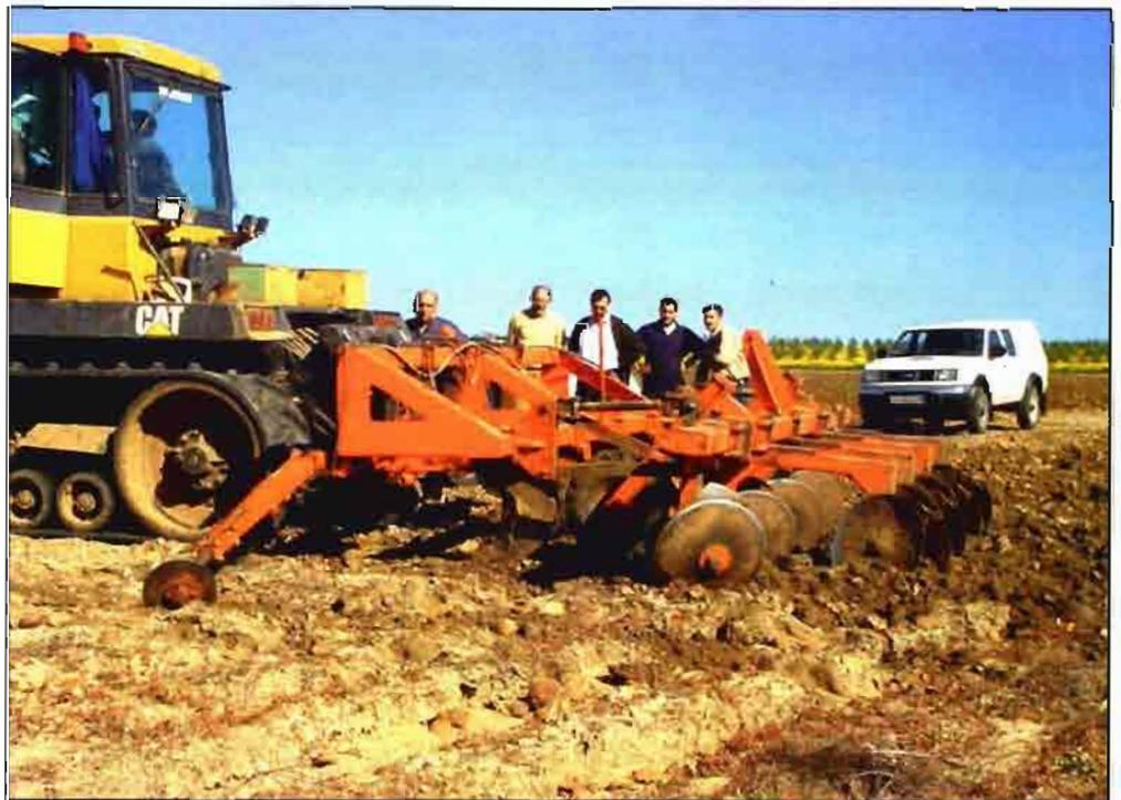
Figura 9. Máquina alomadora de 4 líneas para mínimo laboreo.
