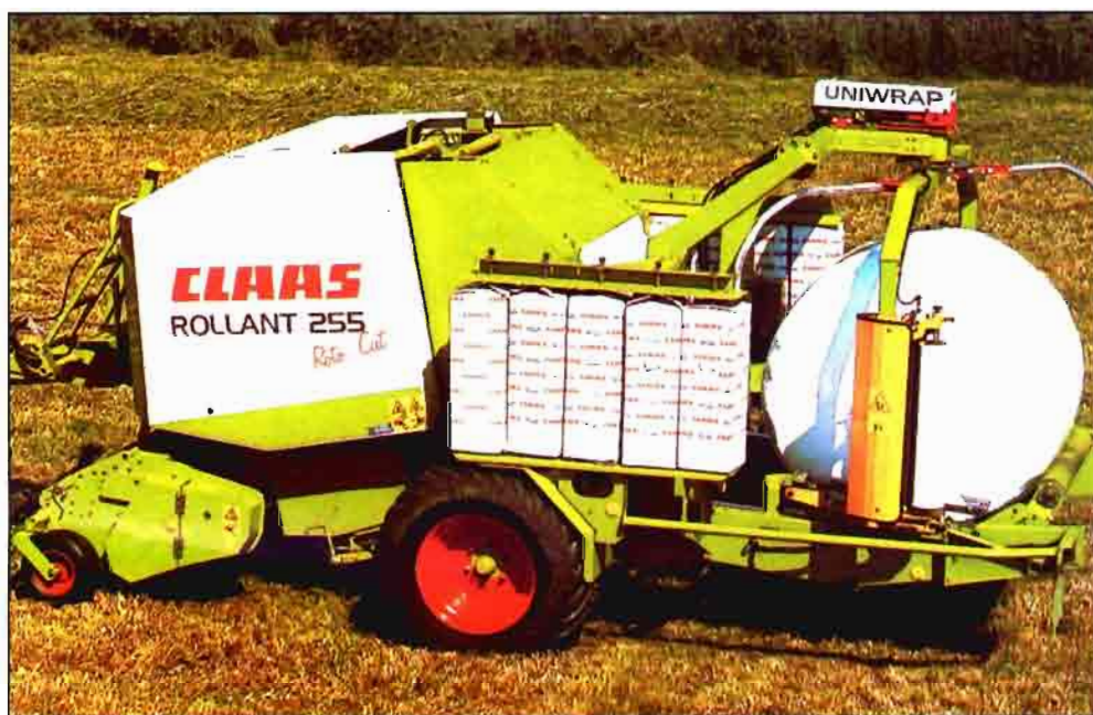
Figura 6. Equipo combinado formado por rotoempacadora y encintadora.
