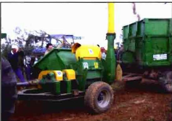
Figura 9: picadora carga manual con sistema de carga a remolque.
