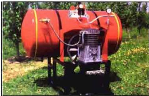
Figura 3: equipo neumático suspendido del tractor para accionamiento de útiles de poda.
