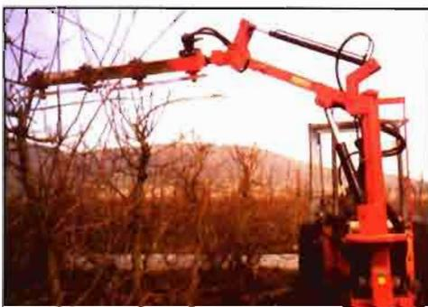
Figura 5: equipo de poda de discos o cuchilla rotatoria.
