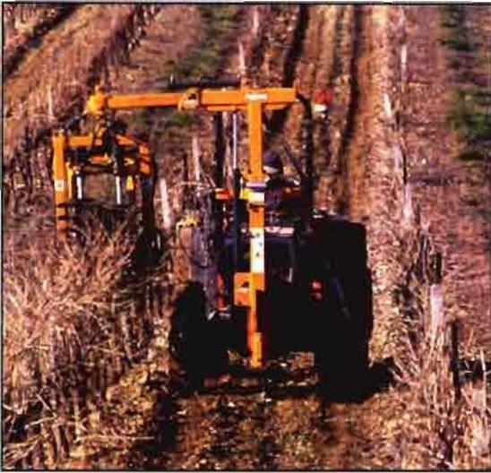
Figura 6: equipo de pre poda específico de viña en espaldera.
