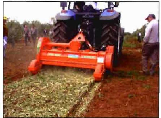
Figura 11: picadora de eje horizontal.
