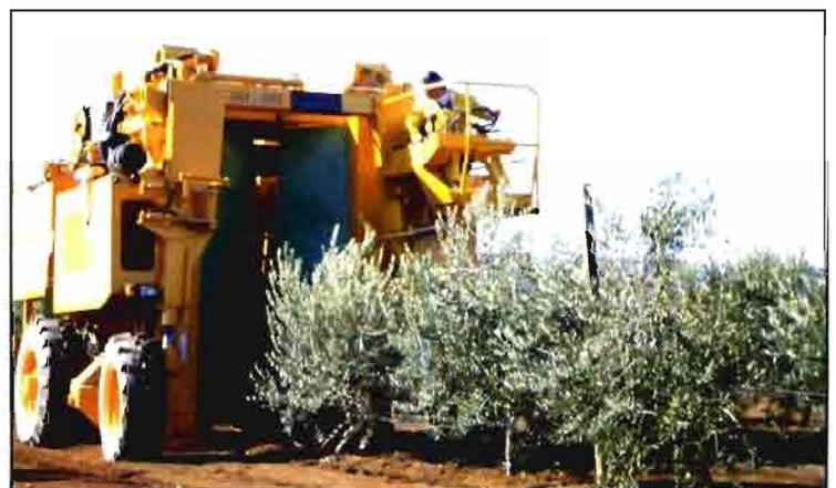
Máquina vendimiadora recolectando mecánicamente una joven plantación de olivar intensiva en Archidona (Málaga), en campo de demostración de la Consejería de Agricultura. Prototipo de la firma Gregoire, con altura y ancho regulables.
