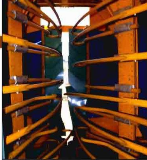
Interior de un prototipo de vendimiadora. Se observan los batidores, elementos que permiten el derribo del fruto.
