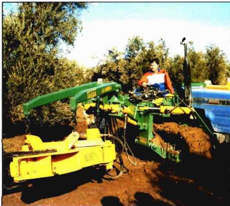
La eficiencia del vibrador afecta a la recolección de aceituna.
