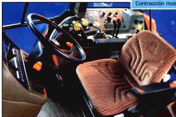
Fig. 3. Selección del tractor con menores niveles de vibración en el puesto de conducción es una medida de prevención.
