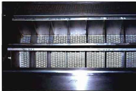
Figs. 5 y 6. Arriba, vista del equipo de micromalteo DANBREW. A la izquierda, detalle de la cabina de procesamiento del equipo de micromalteo DANBREW.
