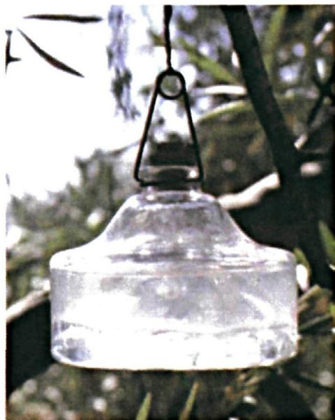
Figura 2: Trampa McPhail de vidrio, variante EFA de Miguel Mollá. Es el soporte utilizado en las combinaciones 2a, 2b y 2c.
