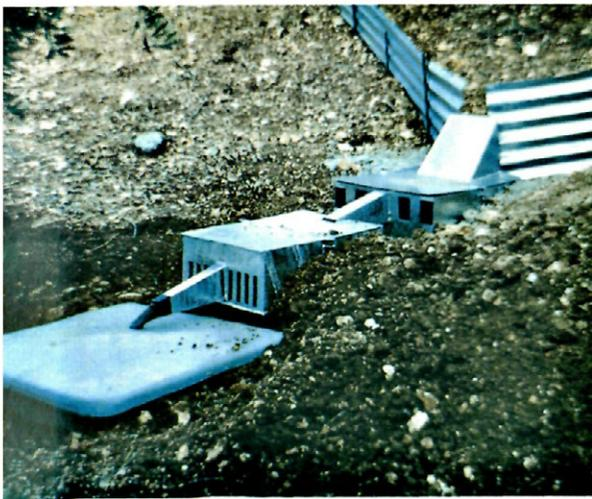
Figura 2.- Detalle del dispositivo de recogida de materiales.
