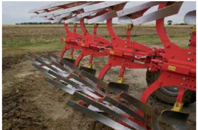
Fotos 5 y 6. Arado Pöttinger Servo 6.50 Nova Plus de siete cuerpos empleado en la prueba de arada.
