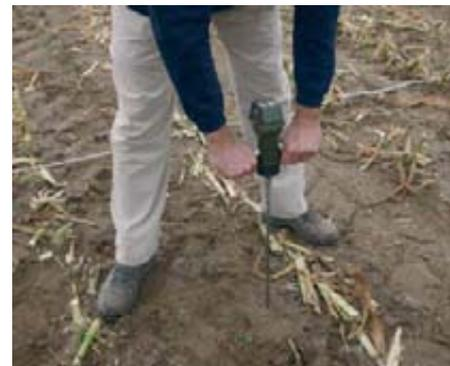
**Fotos 3 y 4.** Toma de muestras de suelo y comprobación de la resistencia a la penetración en varios puntos de la parcela.
