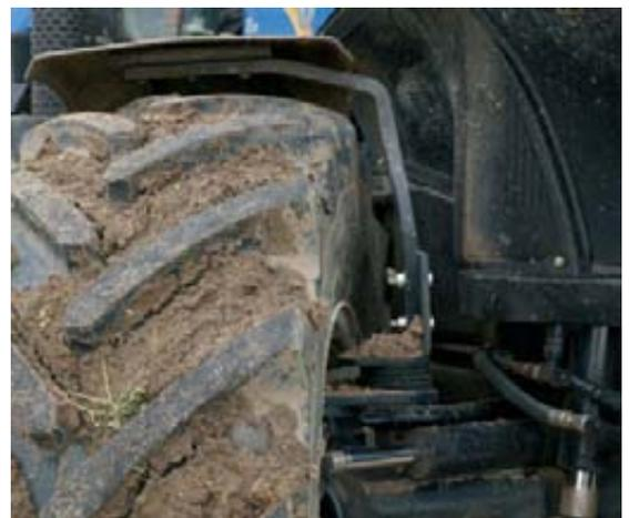
Foto 1. Sistema de giro en el eje delantero del tractor.
