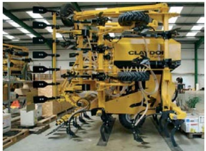
Foto 3. Sembradora Claydon Hybrid, vista lateral en posición de plegado.
