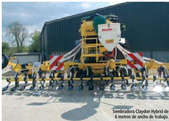
Sembradora Claydon Hybrid de 6 metros de ancho de trabajo.
