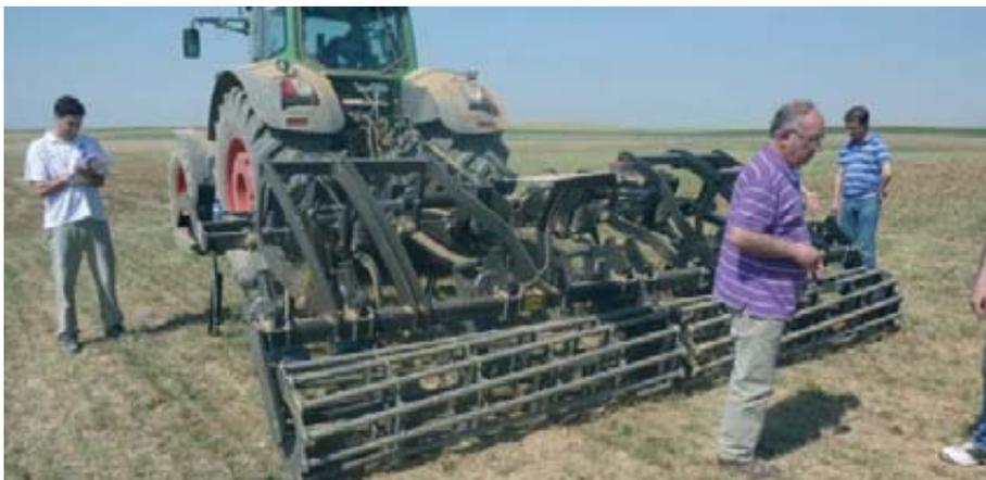
Foto 10 (izda). Rodillo jaula situado en la parte posterior del cultivador. Foto 11 (dcha). Sistema hidráulico de regulación de la profundidad de trabajo del cultivador.
