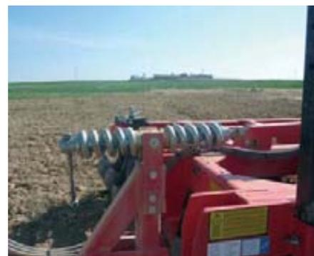
Foto 6 (dcha). Sistema manual para la regulación del ángulo longitudinal de la grada de discos.
