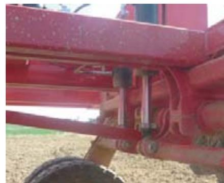
Foto 4 (dcha). Sistema hidráulico de regulación de profundidad de trabajo de la grada de discos.
