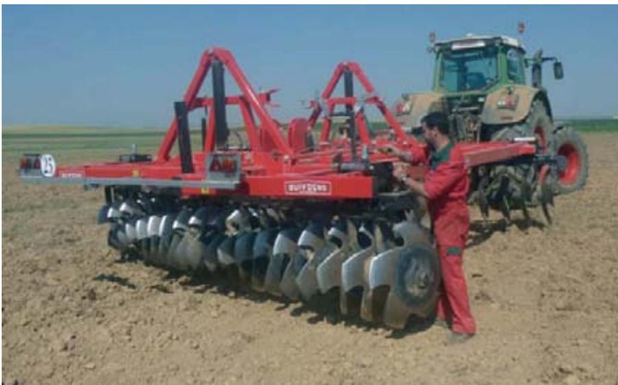
Foto 16. Regulación manual del ángulo de trabajo de la grada de discos.
