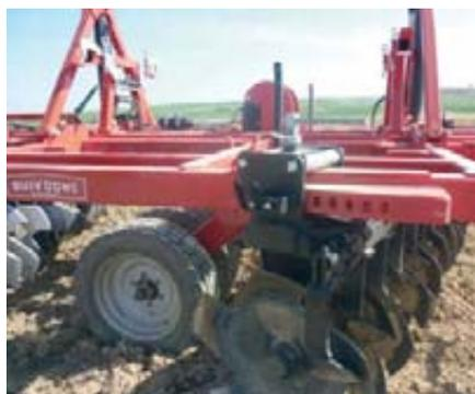
Foto 5. Sistema manual para la regulación del ángulo de la línea de discos.
