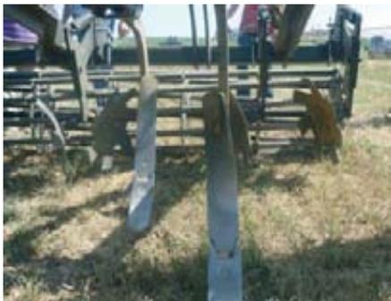
Foto 8. Detalle del alaveo alternativo de la parte superior de la reja del cultivador.
