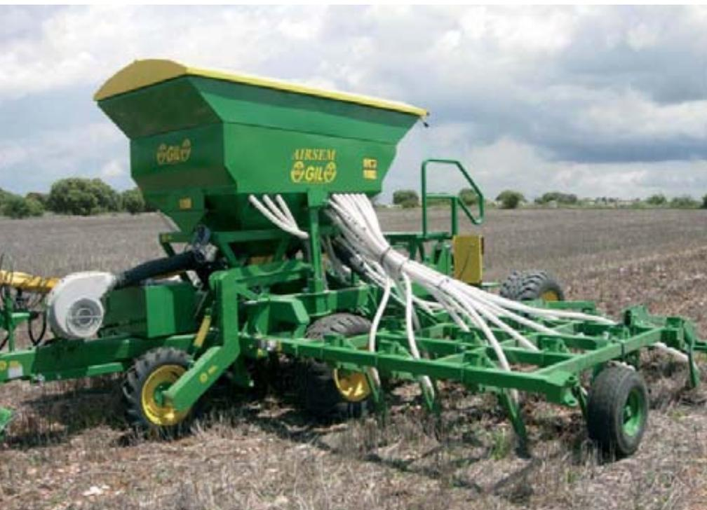
Fotos 3 (izda.) y 4 (dcha.). Los modelos Airsem-4F-SNL son sembradoras a chorrillo neumáticas de siembra directa con reja.
