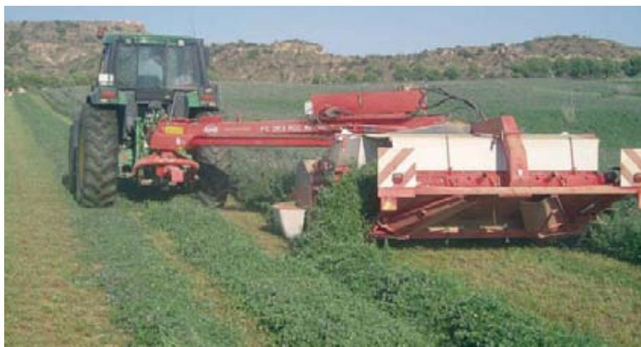
Foto 9. Hileras de forraje depositadas por una segadora con cinta transportadora transversal.
