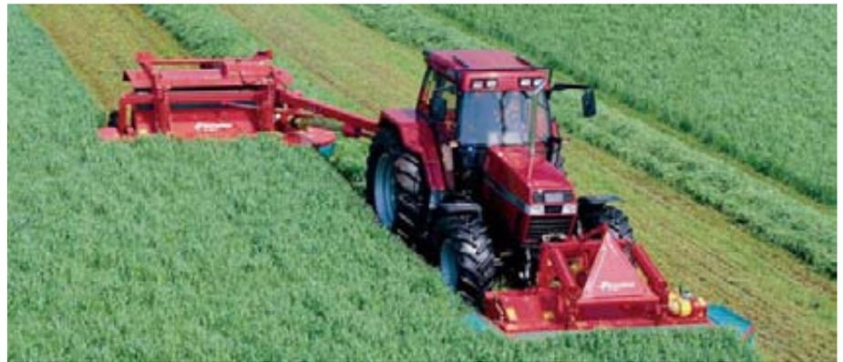
Foto 4. Tractor con segadora frontal y segadora posterior.
