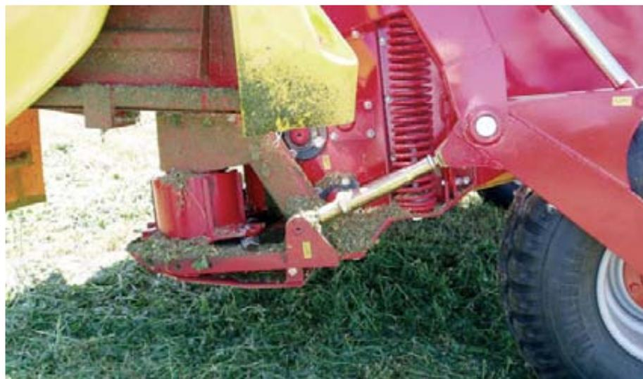
Foto 10. Sistema de regulación de la altura de corte de la segadora.
