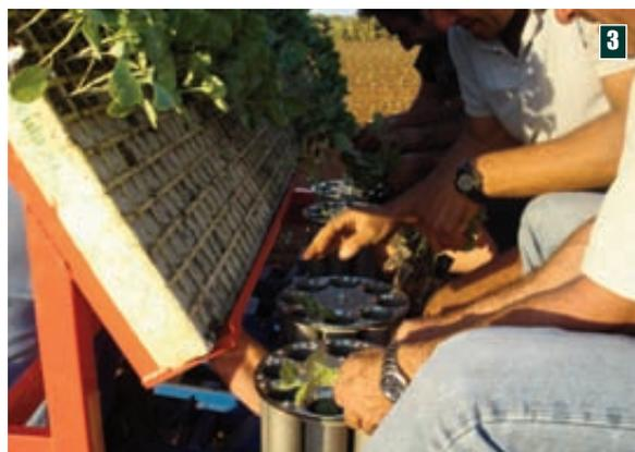
**Fotos 1, 2 y 3.** Se pueden encontrar sistemas de distribución giratoria horizontal, incluso de hasta veinticuatro vasos de fondo abierto, o mediante la colocación en fila de las plántulas para cada una de las líneas de trabajo.
