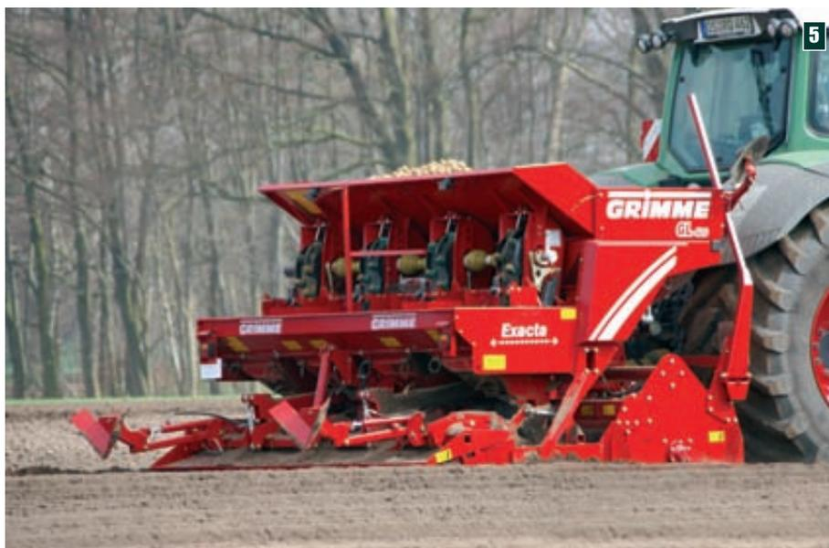
**Foto 5.** El modelo GL 420 de Grimme, presentado en Agritechnica 2011, es una máquina de cuatro surcos con tolva de 2 t de capacidad, que necesita 140 CV para operar.
