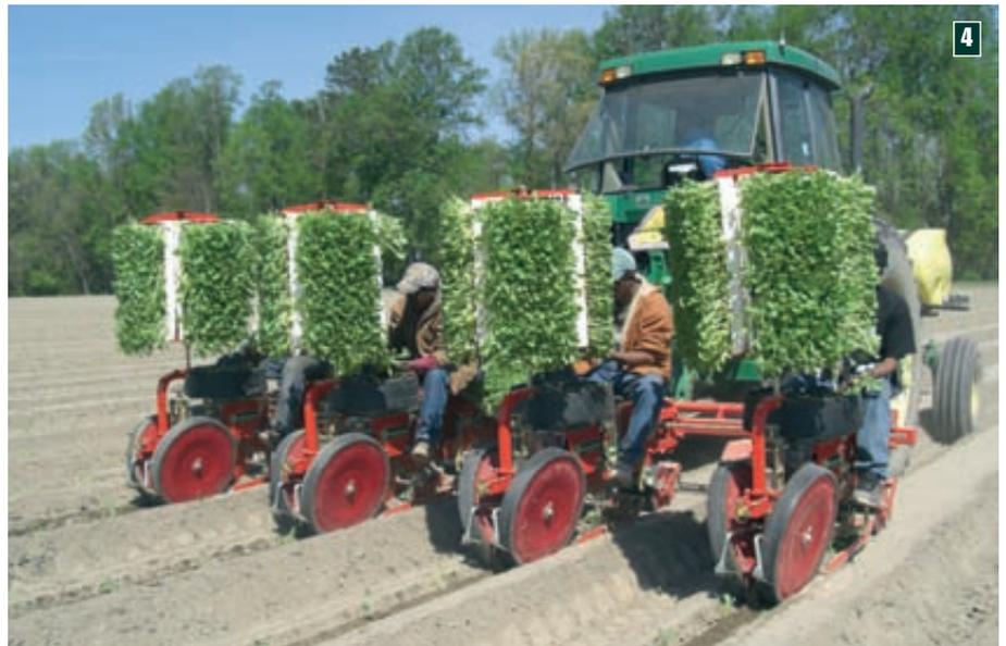
Foto 4. El modelo Trium, de Checchi & Magli, permite una regulación automática de la altura del chasis, gracias a un control electrohidráulico servoasistido.
