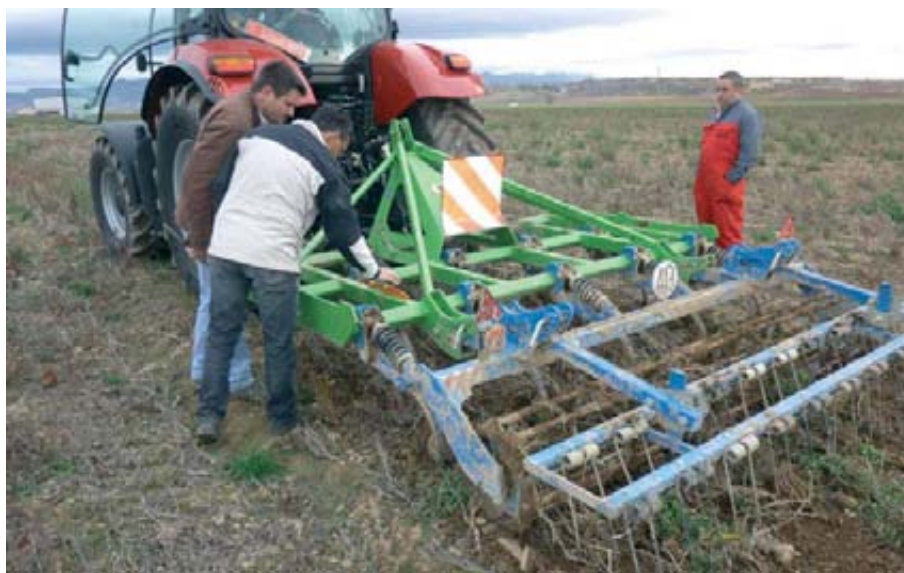
Foto 5. Nivelado del apero previo a la prueba de laboreo.
