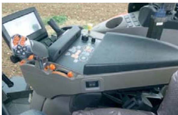
Foto 7. Consola de mando del tractor.
