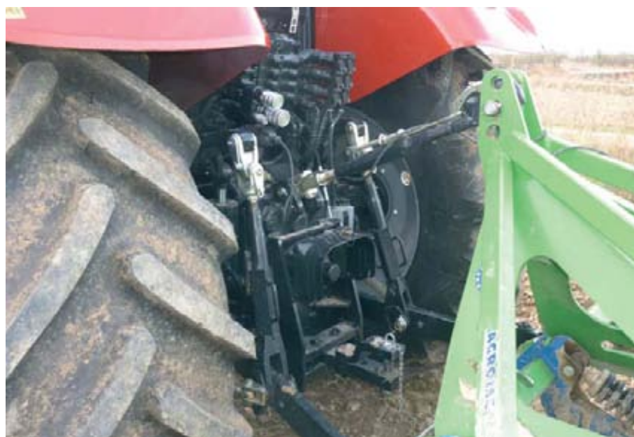
Foto 2. Enganche trasero para remolque arrastrado.
