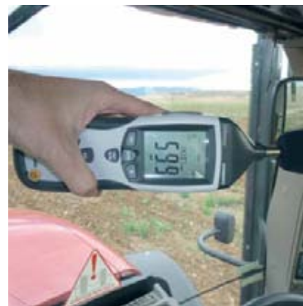
Foto 10. Medida del ruido en cabina con sonómetro.
