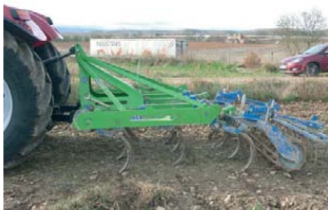
Foto 3. Tractor Case IH Puma CVX 145 EP con apero semichís. Foto 4 (derecha). Detalle del apero semichís utilizado en la prueba de campo.
