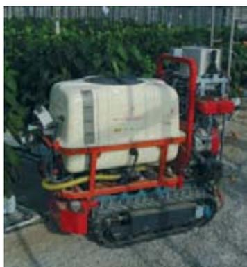
**Foto 2.** Vehículo desarrollado por investigadores de la Universidad de Almería con barras pulverizadoras verticales que permiten realizar tratamientos de forma autónoma sin la presencia de operarios en el interior del invernadero.
