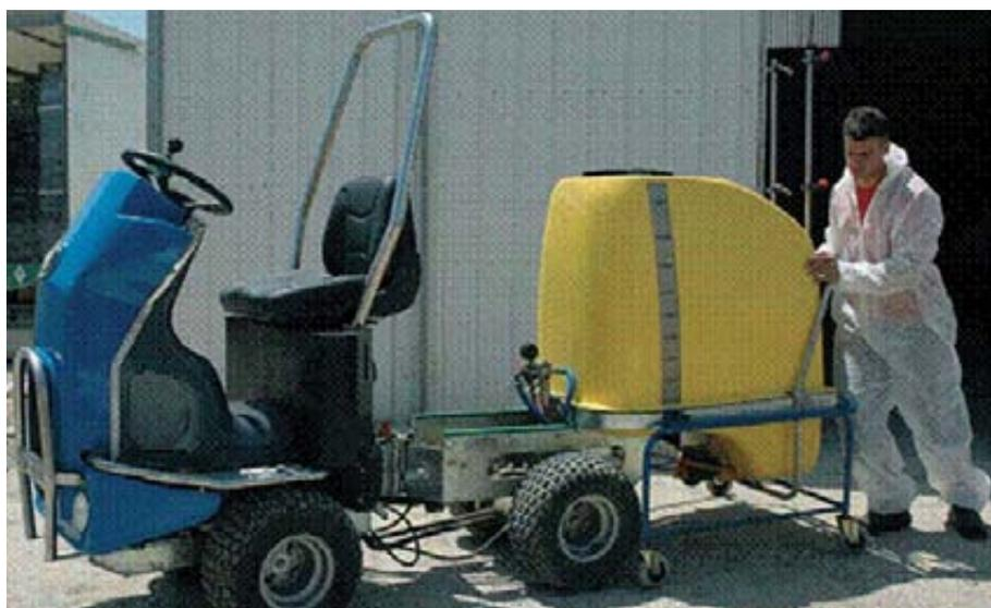
Foto 1. Equipo dotado de barras pulverizadoras verticales que se desplazan entre las líneas de cultivo.
