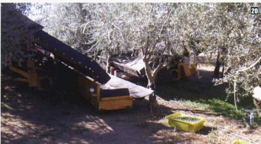
Foto 19. Vibrador con estructura de recepción (paraguas invertido). Foto 20. Plataforma de recogida con vibrador.
