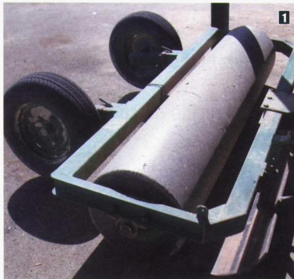
Foto 1. Rulo compactador para la preparación de suelos.
