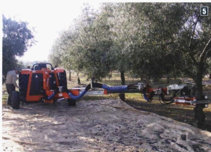
Foto 4. Vibrador de troncos acoplado a la parte delantera del tractor. Foto 5. Vibrador de troncos acoplado a la parte trasera del tractor.
