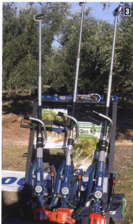
Fotos 2 y 3. Vibrador de ramas de tipo personal.
