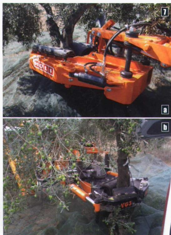
Foto 6. Vibrador de troncos sobre grúa. Foto 7. Sistema de agarre: (a) en tijera; (b) con tres puntos de apoyo.
