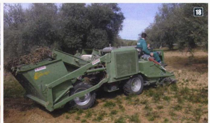
Foto 17. Barredora-recogedora mecánica y limpiadora de campo. Foto 18. Barredora-recogedora-limpiadora.
