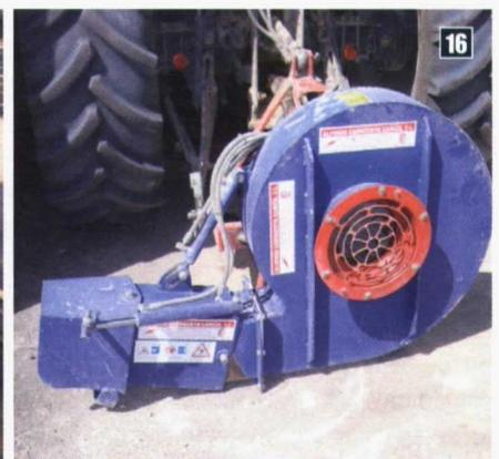
Fotos 14 y 15. Barredora-hileradora mecánica. Foto 16. Barredora-hileradora neumática.
