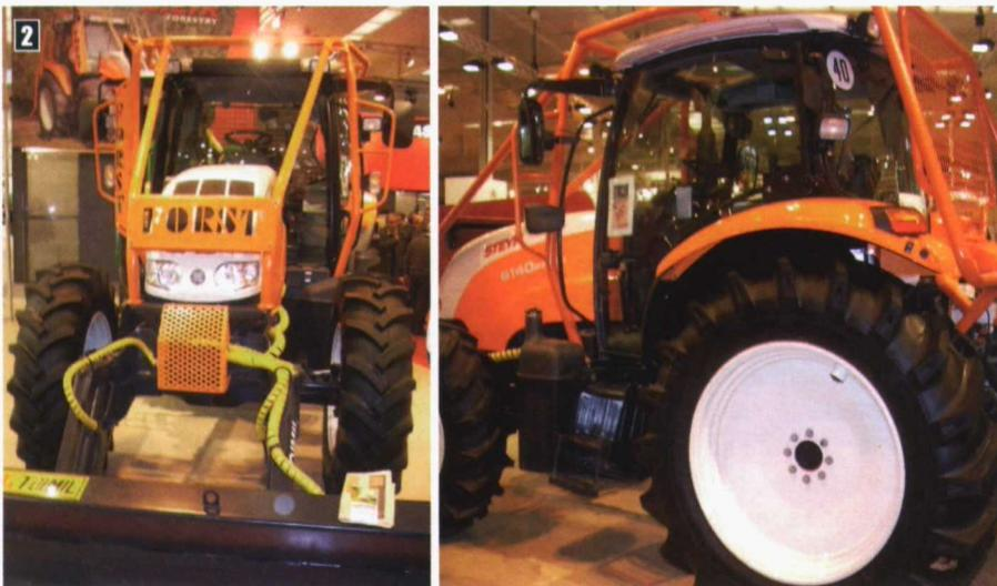
bilidad (lastrado de los ejes), la superación de los obstáculos del terreno (mayor despeje) y la protección de sus elementos (protección de la cabina y del chasis ante la proyección y el impacto de objetos) (foto 2). La potencia debe ser superior a los 80-90 CV. Algunos modelos incorporan una hoja frontal *dozer*, presente en el resto de máquinas forestales, que confiere mayor estabilidad.
