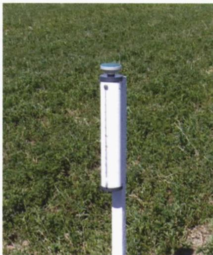
El evaporímetro debe instalarse sobre un poste vertical de madera pintado de blanco a un metro de altura medido desde el suelo.
