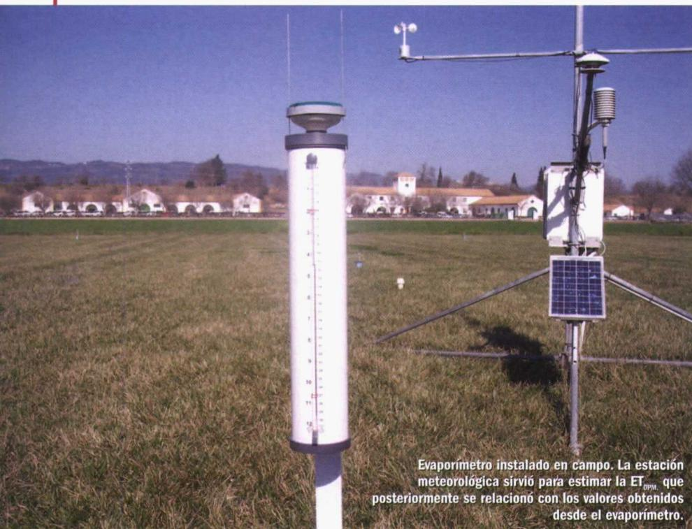
Evaporímetro instalado en campo. La estación meteorológica sirvió para estimar la  $ET_{0ppm}$ , que posteriormente se relacionó con los valores obtenidos desde el evaporímetro.
