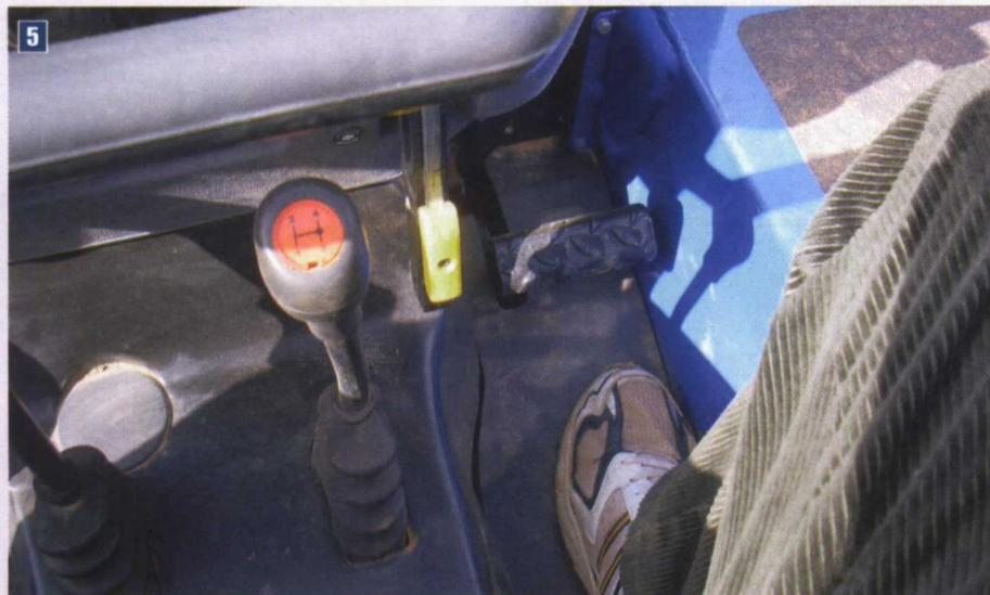
Foto 5. Posición de la palanca de la toma de fuerza.
