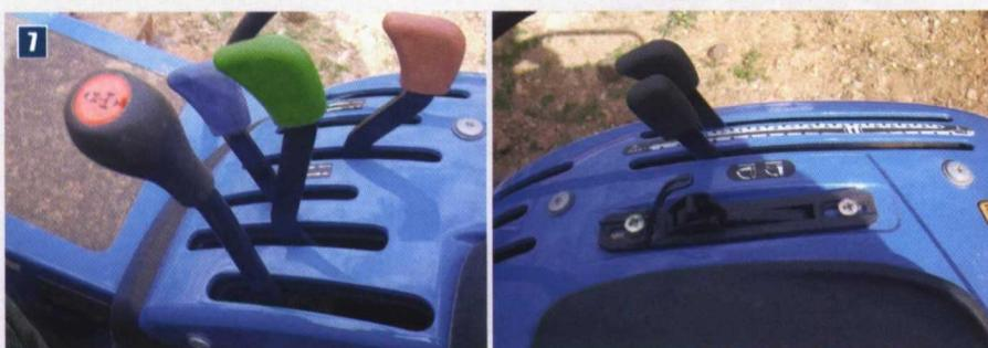
Foto 7. Izquierda: Inversor (palanca negra) y mandos de los distribuidores de servicios externos. Derecha: mandos del elevador hidráulico.
