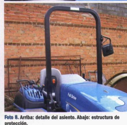
Foto 8. Arriba: detalle del asiento. Abajo: estructura de protección.
