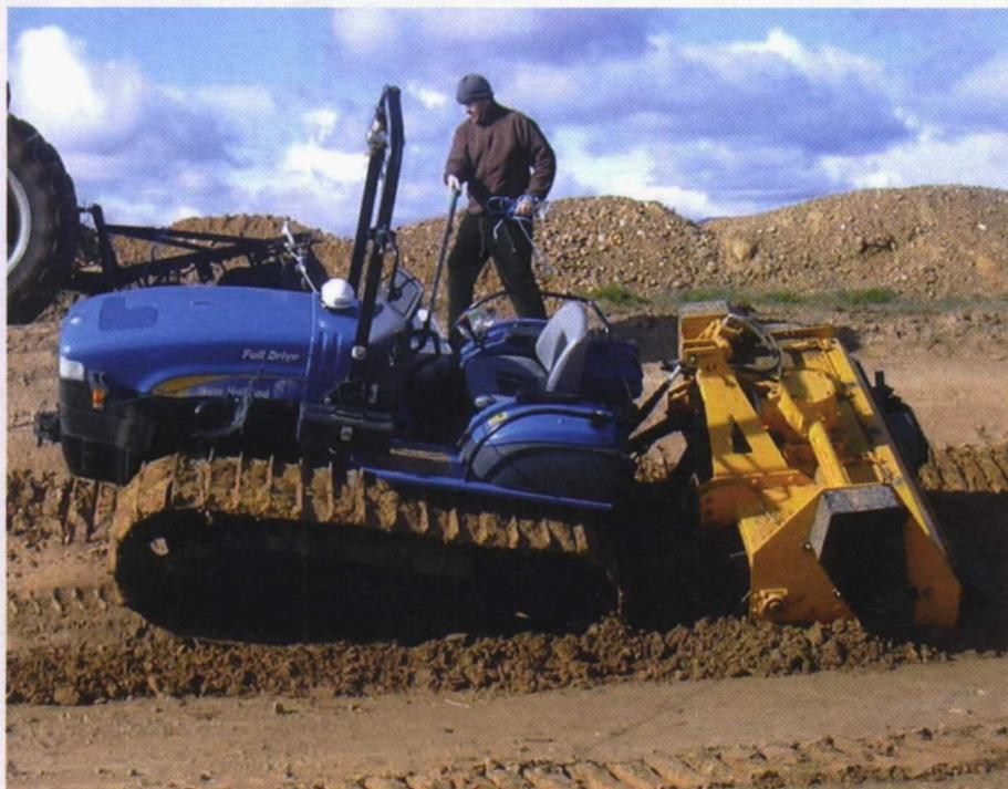
Foto 10 (abajo). Ensayo en pista de una picadora.
