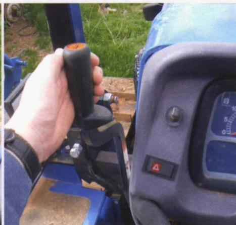
Foto 4. Izquierda: posición del embrague dentro del puesto de conducción. Derecha: accionamiento.
