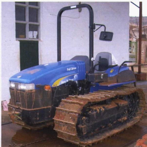
Foto 9 (izquierda). Pesaje del tractor en báscula para determinar la coordenada horizontal del centro de gravedad.
