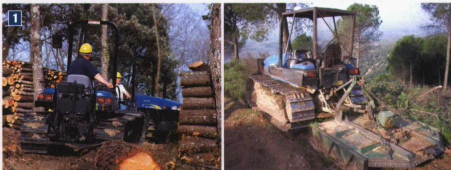
Foto 1. New Holland TK 100A utilizado en operaciones forestales de desbrozado.
