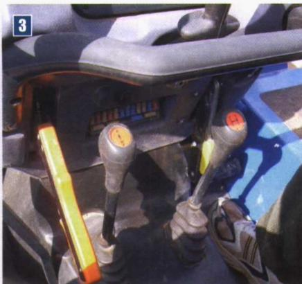
Foto 2. Motor del tractor TK 100A. Foto 3. Palancas de la transmisión y mando de la toma de fuerza (amarilla).
