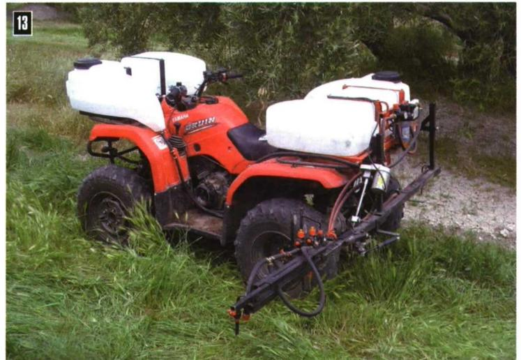
ellas la trayectoria giratoria de las gotas, formadas en la pulverización, favorece que el producto se introduzca en el interior de la vegetación. Van dispuestas sobre portaboquillas en forma de T, con dos boquillas de distinto diámetro para diferentes usos.
