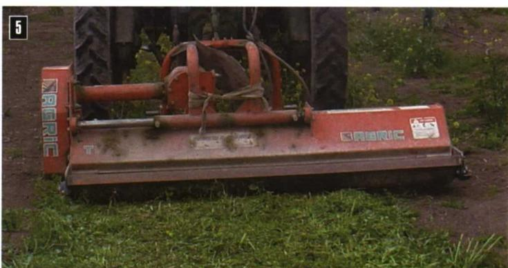
Foto 3. Vibrocultivador. Foto 4. Rulo compactador. Foto 5. Desbrozadora de martillos.
