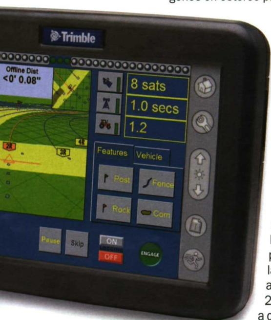
Foto 1. Pantalla táctil usada en equipos de guiado automático.
