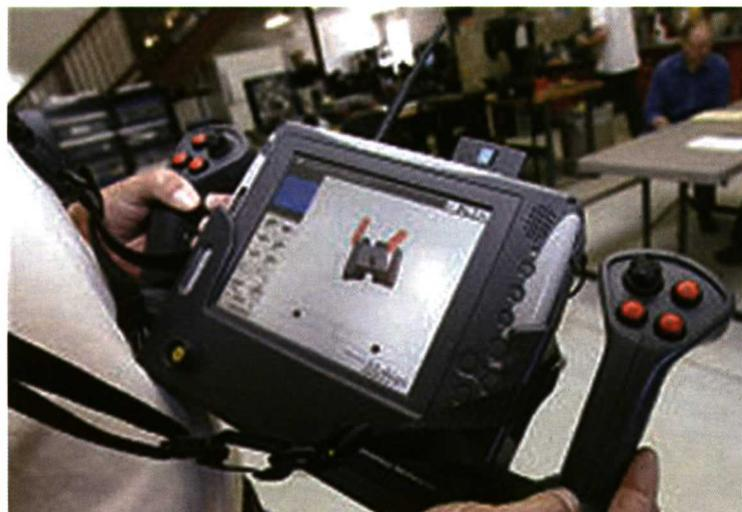
Foto 3. Consola para el control del tractor a pie de parcela.
