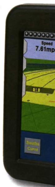
La mayoría de los sistemas de guiado automático emplean sistemas inerciales (giróscopos y acelerómetros) colocados en cajas metálicas en la cabina. La velocidad a la que se actualizan las coordenadas es también un dato importante. Cuanto mayor sea la frecuencia de actualización menos posibilidades de error tendrá el sistema. Se emplean frecuencias que oscilan entre 5 y 20 Hz.
