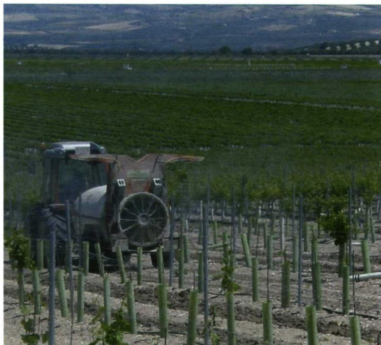
Foto 13. Atomizador con pantallas horizontales.
