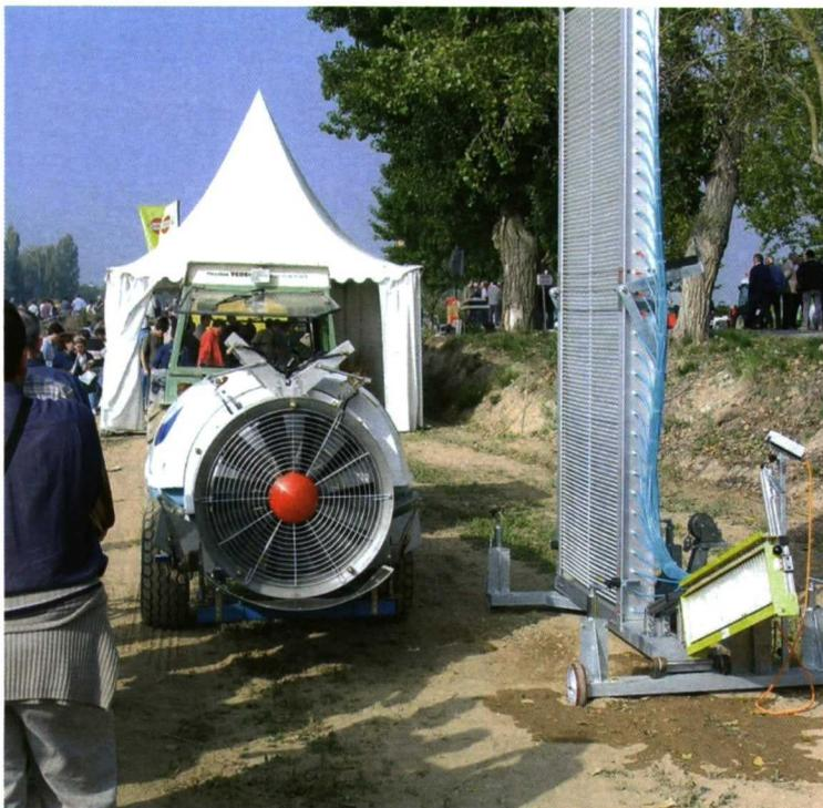
Foto 19. Equipo para la medida de la distribución vertical del líquido.
