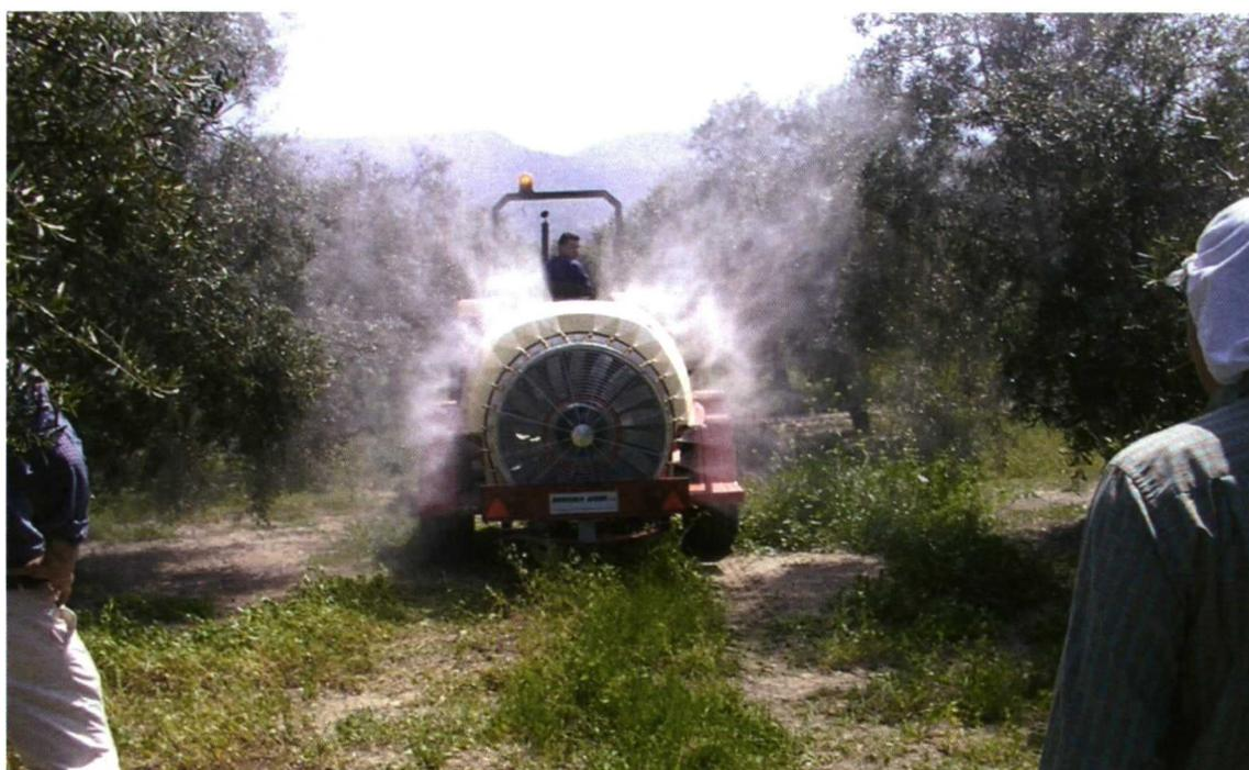
Foto 1. Atomizador empleado en olivar.
