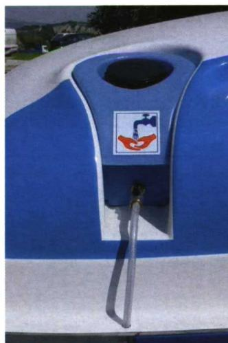
Foto 4. Depósito de agua limpia para el operario.
