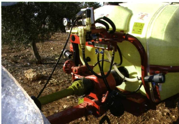
Foto 7. Distribuidor, manómetro y válvula de presión. En la parte inferior derecha también se observa el filtro en la aspiración y en los laterales los detectores de presencia de árboles.
