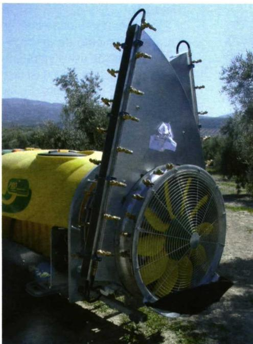
Foto 12. Atomizador con ventilador de flujo axial y pantallas verticales.
