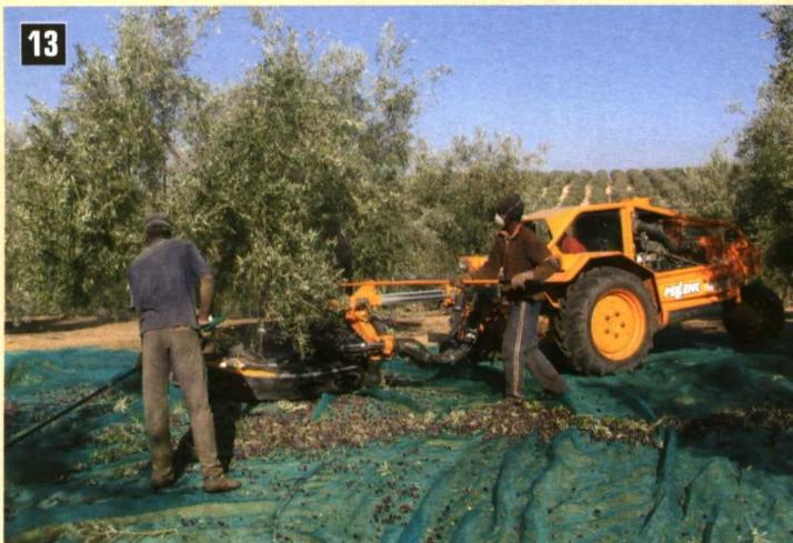
Foto 13. Vibrador autopropulsado.
