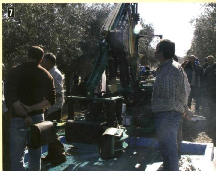
Foto 6. Vibrador acoplado en la parte trasera del tractor.
