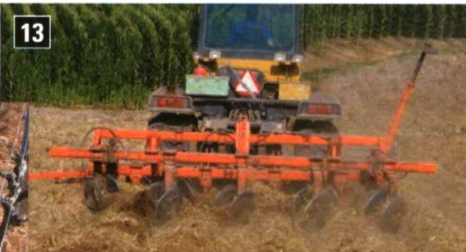
Foto 9. Equipo combinado para preparación del suelo y siembra. Foto 10. Azadas giratorias. Fotos 11 y 12. Cultivador de discos. Foto 13. Alomadora de discos. Foto 14. Cultivador de estrellas rotativas para control de hierbas y realzado del lomo. Foto 15. Cultivador intercepas.
