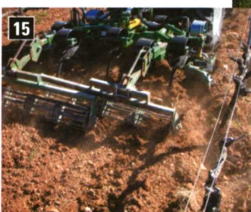
Foto 9. Equipo combinado para preparación del suelo y siembra. Foto 10. Azadas giratorias. Fotos 11 y 12. Cultivador de discos. Foto 13. Alomadora de discos. Foto 14. Cultivador de estrellas rotativas para control de hierbas y realzado del lomo. Foto 15. Cultivador intercepas.
