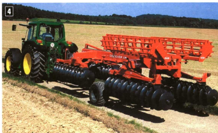
Foto 4. Grada de discos en tándem con sistema hidráulico de plegado horizontal para transporte.
