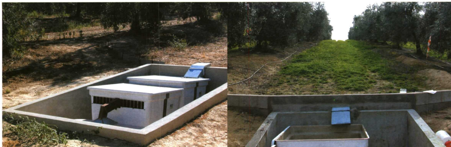
Foto 2. Vista de la parcela de escorrentía de Benacazón (cubierta) y sistema de recogida.
