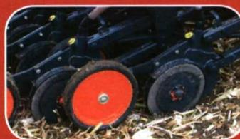
Discos sembradores sobre paralelogramo: siembra de profundidad homogénea.
