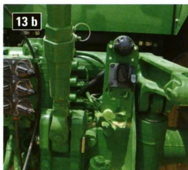
Foto 13. Conector ubicado en la parte trasera del tractor (13a y 13b) y terminal virtual (13c) del sistema Isobus.
