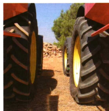
Foto 8. Tractor equipado con neumáticos convencionales (izquierda) y de baja presión (derecha).
