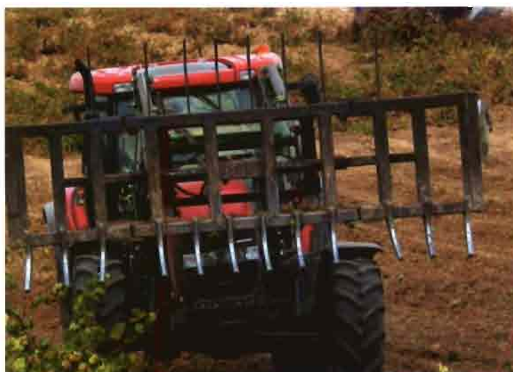
Foto 2. Pinza para la recogida de cepas.
