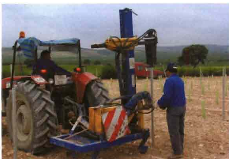
Foto 7. Máquina clavadora de postes.
