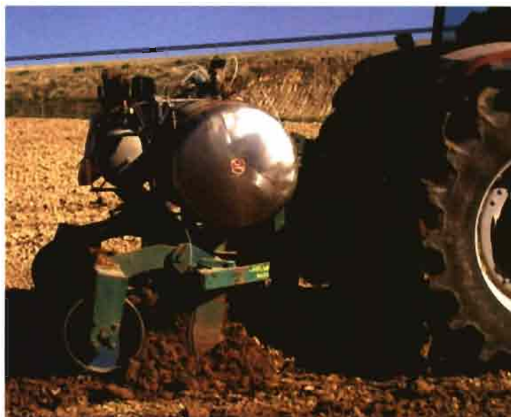
Foto 5. Equipo de desinfección de suelo.
