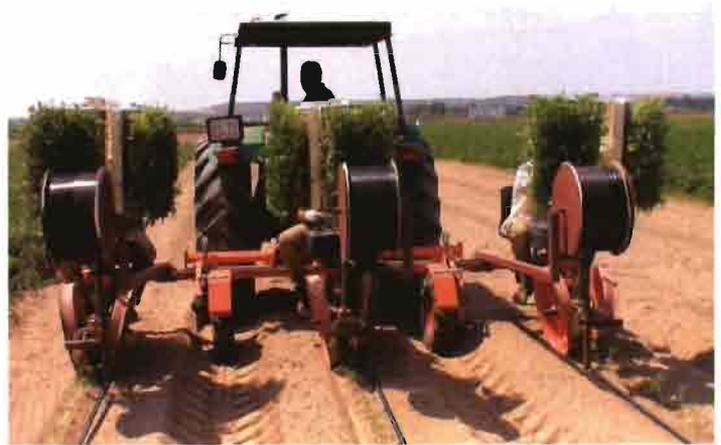
Foto 1. Trasplante con cepellón y colocación de las cintas de goteo.
