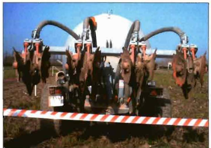
Foto 2 (arriba). Maquinaria para la aplicación de purines al suelo.
