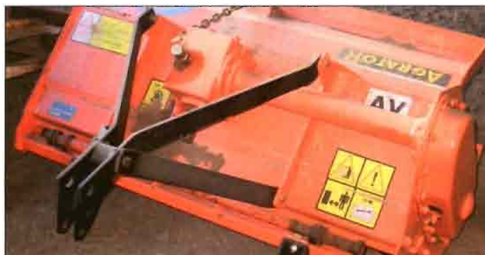
Foto 6. Resguardos de protección en una fresadora.
