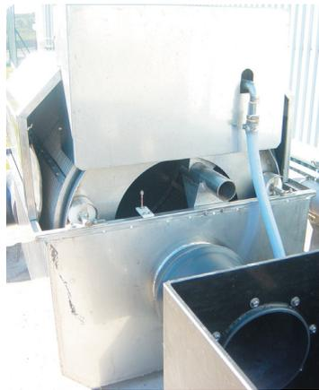
Filtro rotativo de malla 60 µm y capacidad 350-450 m<sup>3</sup>/h.
