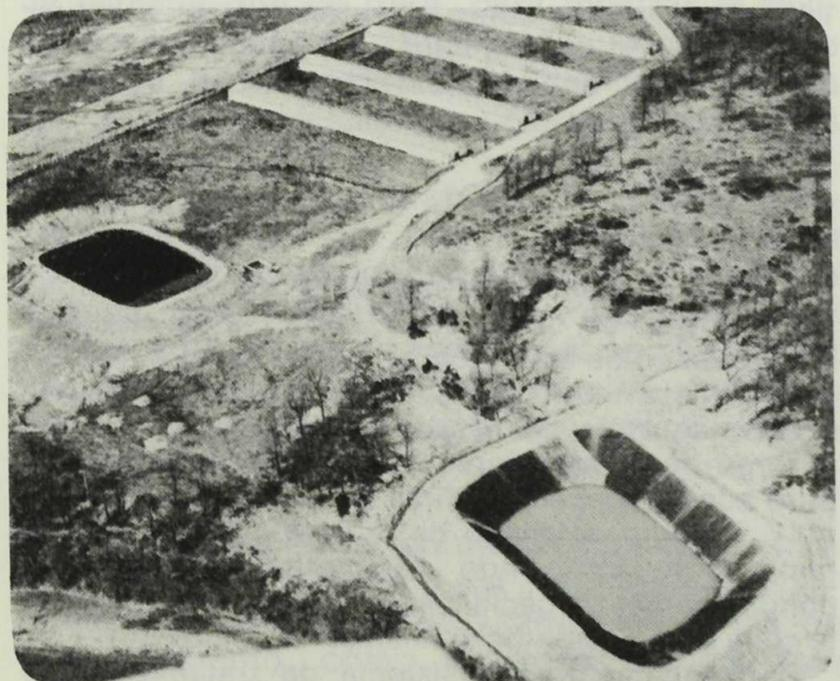
Fig. 3.—Balsas anaerobias de la granja n.º 2.
