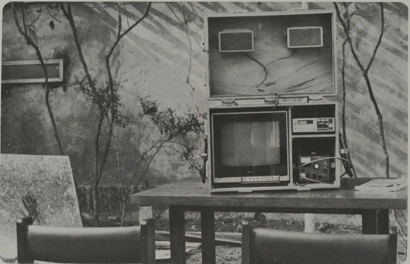
*Módulo de capacitación audiovisual diseñado y empleado por el CESPAC (Centro de Servicios de Pedagogía Audiovisual para la Capacitación) del Perú, que consta del embalaje para el transporte, monitor a color, adaptador para corriente de batería, videoreproductora y altavoces complementarios*
